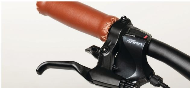
Die Griffweite des Hebels kann an der kleinen Madenschraube justiert werden.
