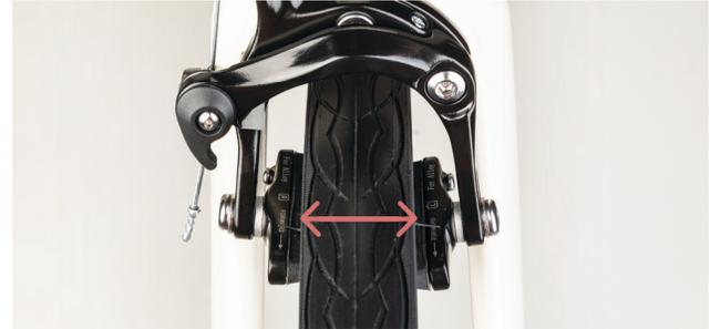
Wenn das Rad montiert ist, drücke den Schnellspanner an der Bremse nach unten! Diese spezielle Klemmvorrichtung dient der Erleichterung bei der Montage und Demontage des Vorderrades.
