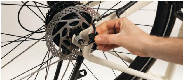
2. Löse die Mutter auf beiden Seiten der hinteren Radachse mit einem 17er Schlüssel (Maulschlüssel).
