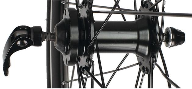
3. Das Vorderrad wird nun zwischen die Gabel geschoben. Die Aufnahmen der Gabel müssen auf die noch lockere Achse greifen.
