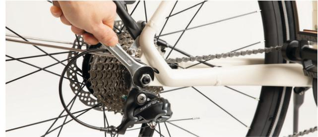
3. Entferne die Mutter, die Beilagscheibe sowie die Drehmomentsperre auf beiden Seiten und führe das Hinterrad aus dem Rahmen.
