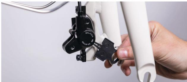
7. Achte darauf, dass sich der Schnellspanner auf der gegenüberliegenden Seite der Scheibenbremse befindet.
