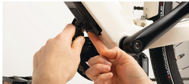
3. Löse danach die Zusatzsicherung und entnimm den Akku dabei aus dem Rahmen. Die Zusatzsicherung ist der kleine Hebel, der ein Herausfallen des Akkus verhindert.
