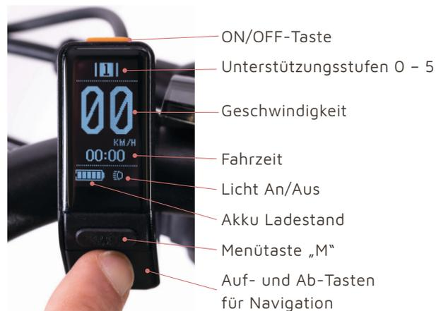
Das Display-Licht kann optional aus- und eingeschalten werden. Halte dazu Dazu die „Nach oben“-Taste für 5 Sekunden gedrückt halten. Es erscheint dann ein kleines Licht Symbol rechts unten am Display.
