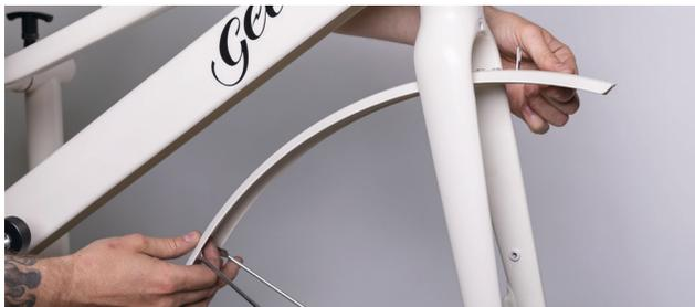
3. Setze oben die Schraube ein und ziehe sie mit dem 5 mm Inbusschlüssel (Sechskantschlüssel) hinten und vorne fest.
